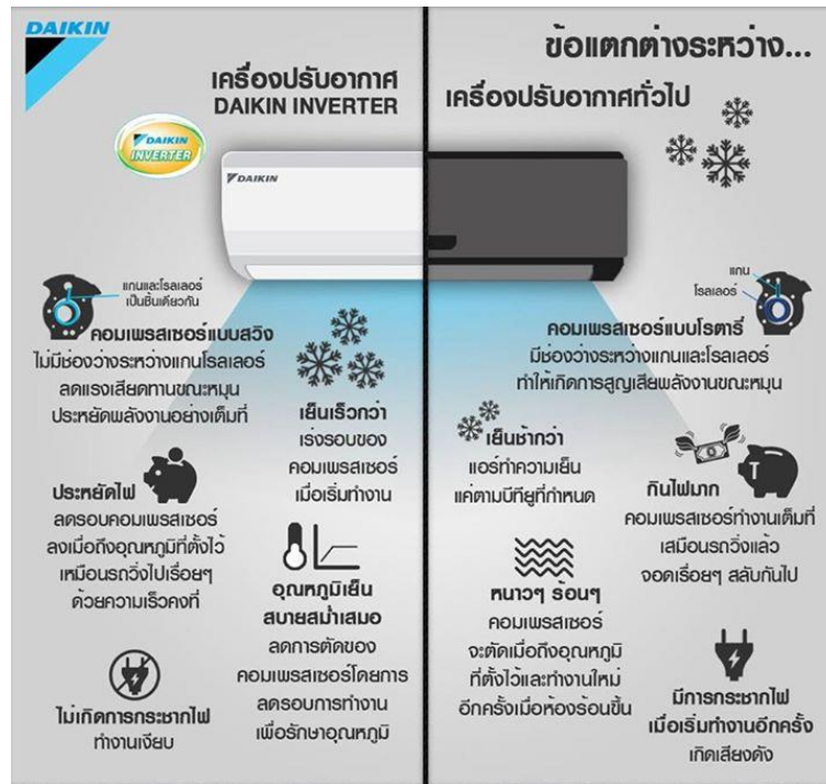
ภาพที่ ๔ เปรียบเทียบข้อแตกต่างระหว่างเครื่องปรับอากาศระบบธรรมดา กับระบบอินเวอร์เตอร์ (แหล่งที่มา : https://www.daikin.com/ )
