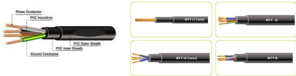
ภาพที่ ๒๒ สายไฟฟ้าประเภท NYY เป็นสายหลายแกนเปลือก ๒ ชั้น (แหล่งที่มา : มาตรฐานการติดตั้งทางไฟฟ้าสำหรับประเทศไทย พ.ศ.๒๕๕๖ วสท.๒๐๐๑-๕๖)
