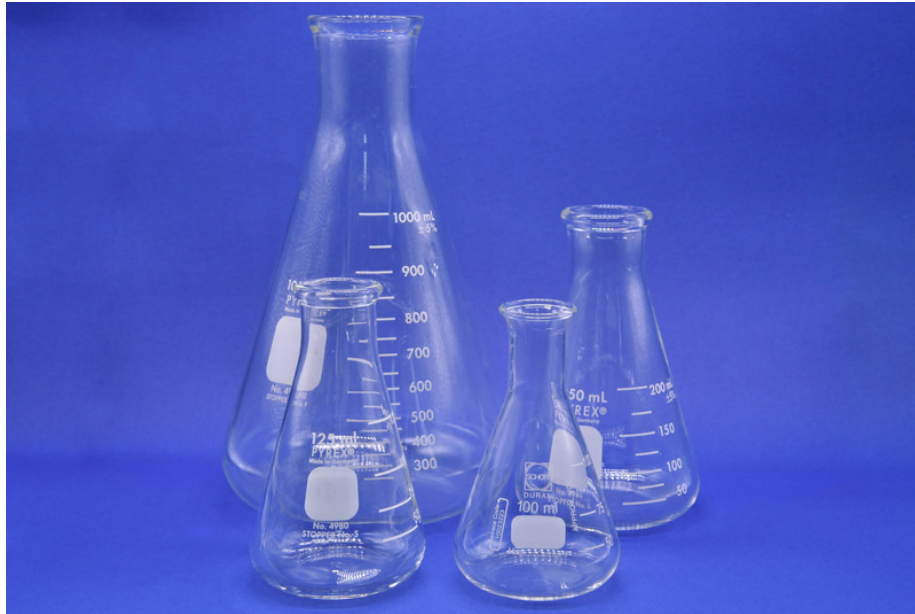
รูปที่ 7 Erlenmeyer flask ขวดรูปชมพู่ ที่มา: https://www.bsmartsci.com/product
