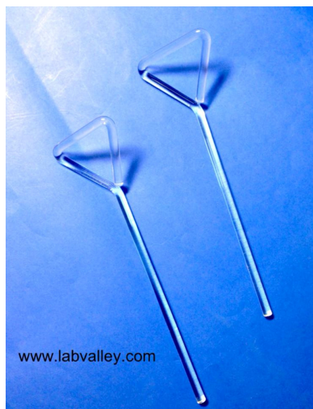
รูปที่ 10 Spreader คือ แท่งแก้วสามเหลี่ยม หรือแท่งแก้วปาดเชื้อ
