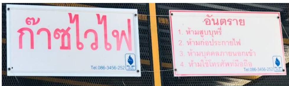
รูปที่ 4-1 คำเตือนก่อนปฏิบัติงานใด ๆ ในสถานีก๊าซ
