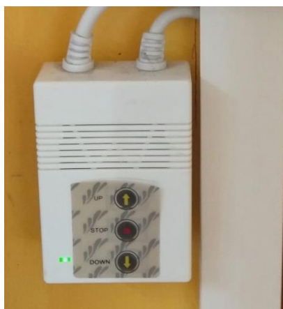
ภาพที่ 3-33 แสดงการใช้รีโมทเลื่อนจอร์บภาพ
