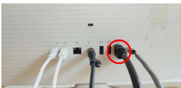
ภาพที่ 3-29 แสดงการต่อสาย HDMI และ VGA
