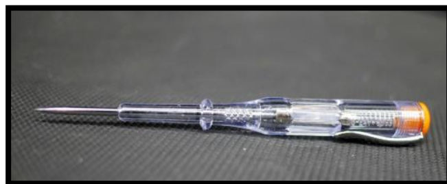
ภาพที่ ๗ แสดง ไชคองเช็คไฟ (Test Current Voltage)
