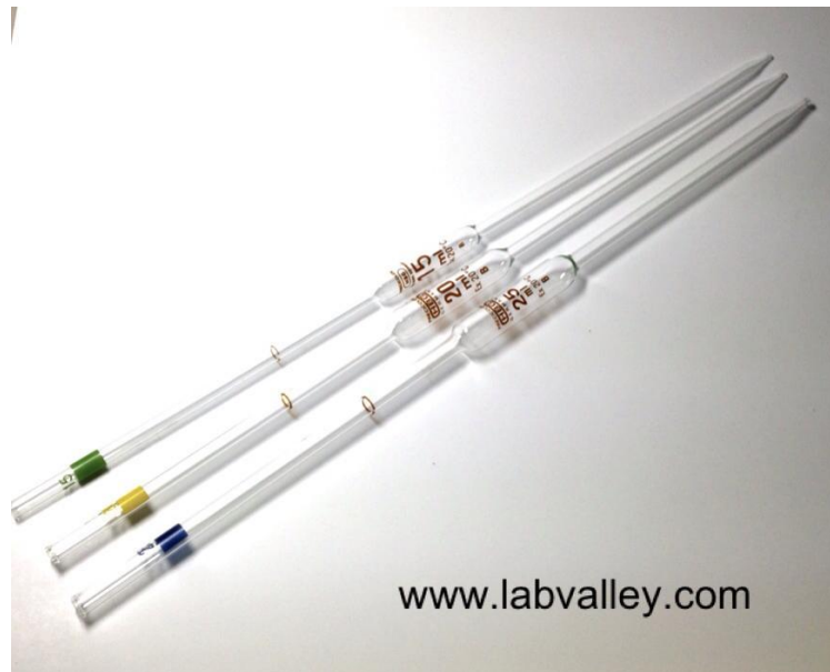
ปิเปตต์ขนาดเดียว (Volumetric pipette) : ใช้ในการดูดสารละลายที่ต้องการปริมาตรที่แน่นอน (ปิเปตต์ได้เพียงปริมาตรเดียว)
